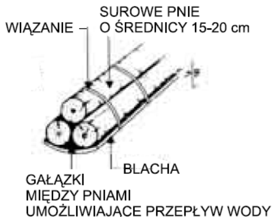
Ryc. 18. „Dreny” z kłód (pni) umożliwiające przepływ wody.
