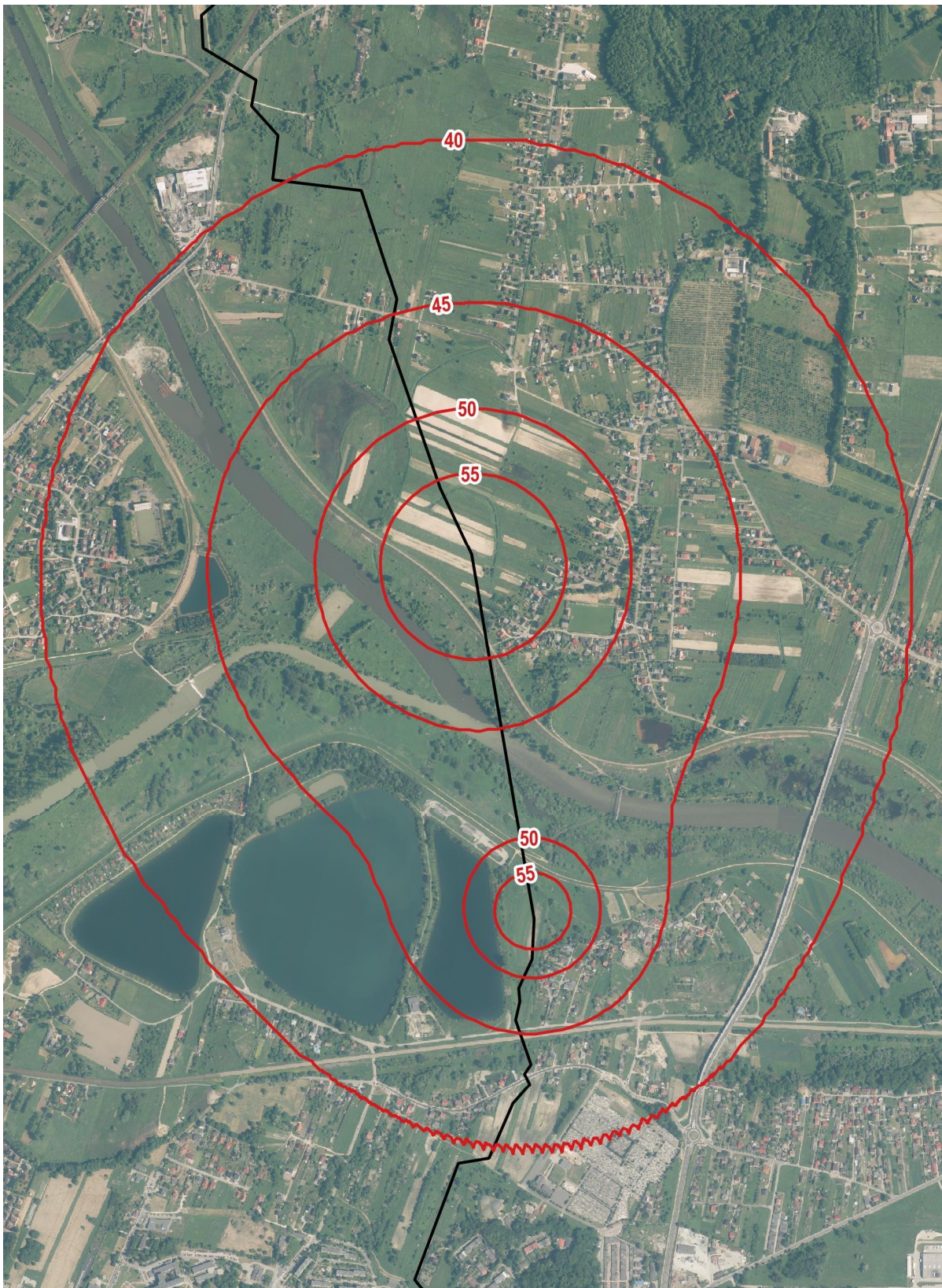
Rysunek 37. Rozkład przestrzenny izofon w fazie budowy dla przewiertu sterowanego HDD pod rzeką Wisłą (wariant I) – skala 1:15 000
