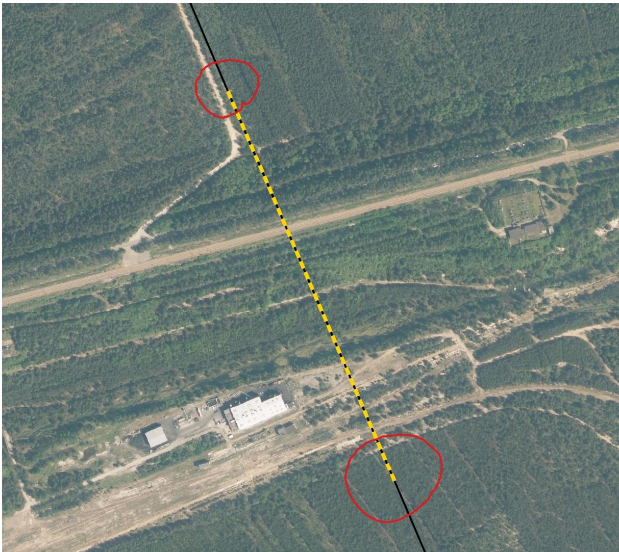
Rysunek 23. Zasięg przestrzenny ponadnormatywnego oddziaływania na powietrze atmosferyczne w fazie budowy dla przewiertu HDD pod ul. Bukowską, linią kolejową nr 156 i Kanątem Głównym (wariant I) – skala 1:5 000
