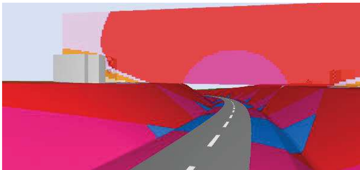
Rysunek 21 Przykładowy raster pionowy rozprzestrzeniania się dźwięku – charakterystyka rozchodzenia się dźwięku od drogi w wykopie z uwzględnieniem różnic poziomu dźwięku w punktach odbioru (receptorach) /źródło: Mosty Katowice/
